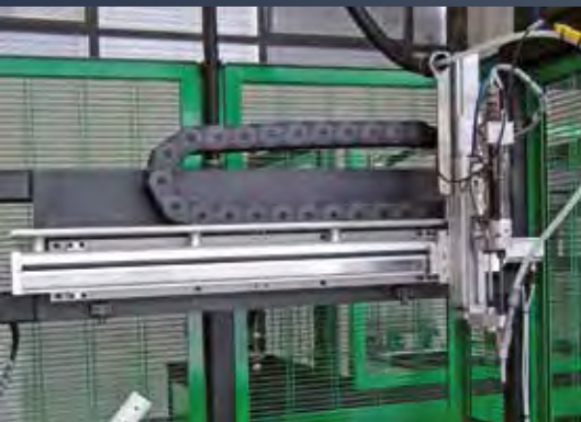
MCA su assi cartesiani x, y MCA on Cartesian X-Y axes
